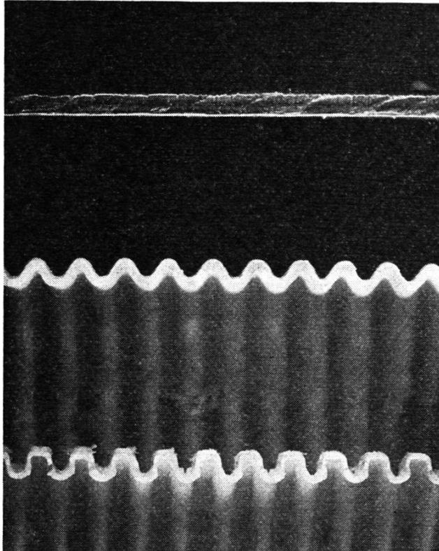
*Bild 1:* Wandprofile einiger handelsüblicher flexibler Dränrohre mit  $\varnothing$  50 mm (die Innenseiten der Rohre zeigen im Bild nach unten). Oben: Glattes Rohr aus Polyäthylen. Darunter: Gewellte PVC-Rohre mit unterschiedlicher Profilierung
