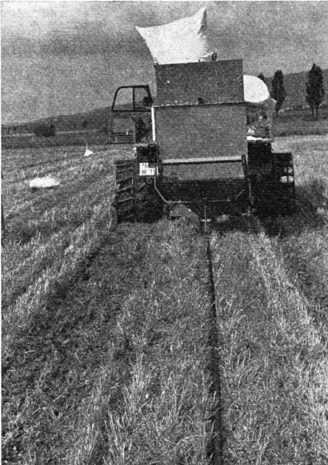
*Bild 5:* Bodenschlitzgerät mit Styromull-Fülltrichter
