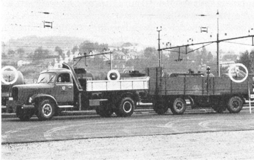
Abb. 7: Saurer DU5 mit Anhänger und installierten Markierungsscheinwerfern.
