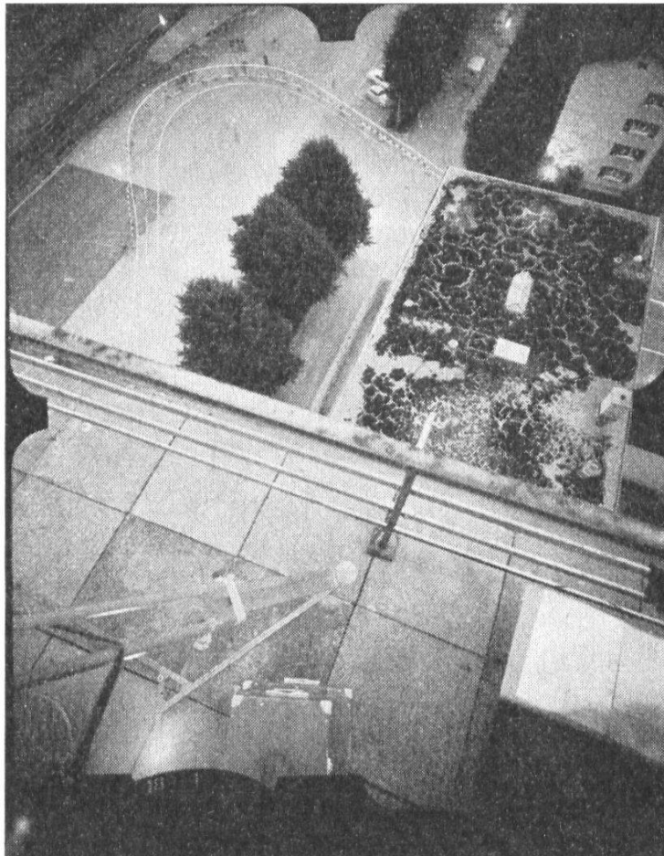
Abb. 5: Die Meßaufnahme vom 29. August 1967, 19.30 Uhr, gibt einen Überblick über die Versuchsanordnung. Innerhalb der 4 Paßpunkte findet die Richtungsänderung statt. Die Fahrspuren «schweben» 2,25 m über Boden in der Paßpunktenebene (vgl. Abb. 7).
