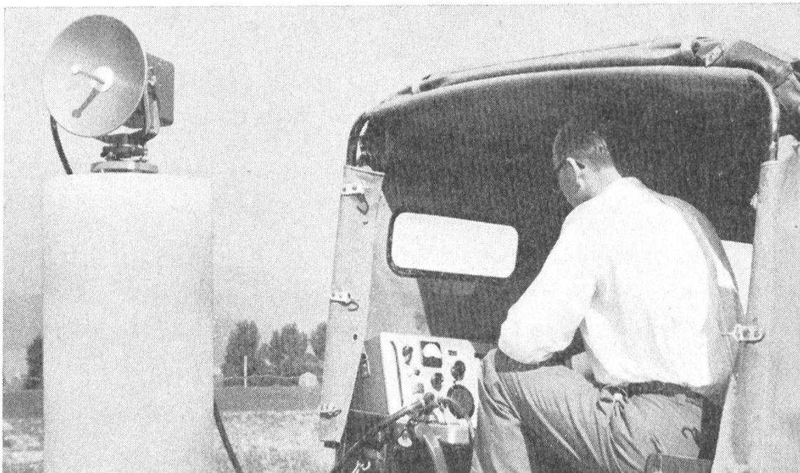
Der Wild DI 50 Distomat ist ein automatisches elektronisches Distanzmessgerät, das mit 3 cm-Trägerwellen arbeitet. Sein grosser Vorteil liegt in der Trennung von Mess- und Antennenteil, die, durch ein Kabel verbunden, bis zu 30 m voneinander aufgestellt werden können. Der Messteil kann daher im Fahrzeug oder an einem geschützten Standort bedient werden, während der Antennenteil auf einem Stativ, Gerüst oder Turm über dem Messpunkt steht.
