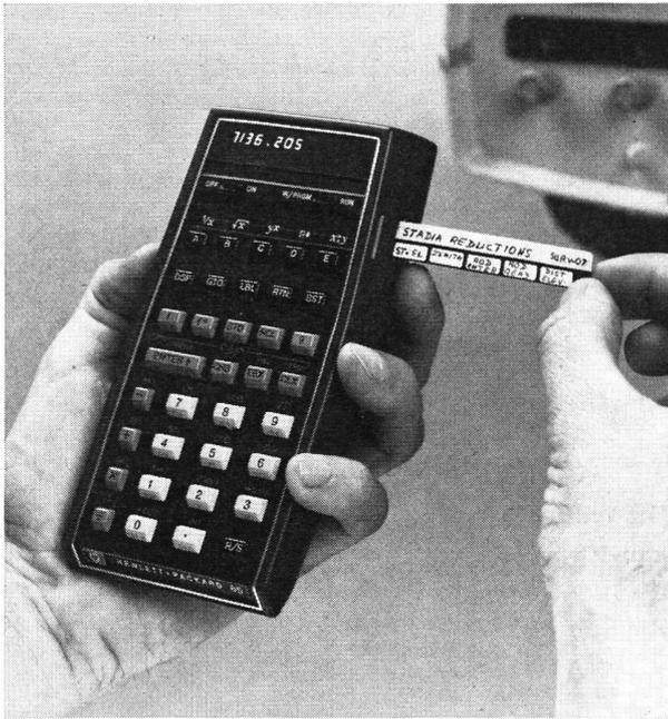
Les géomètres, topographes, spécialistes en génie civil peuvent mettre au point sur le HP-65, nouveau calculateur de poche programmable et à cartes magnétiques, leurs propres applications ou utiliser pour les problèmes les plus courants, la bibliothèque de programmes pré-enregistrés, développée par Hewlett-Packard. Le clavier du HP-65 offre 51 fonctions au total.
