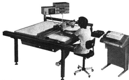
Normalausführung mit Koordinatenanzeige auf Zifferblatt oder digital auf elektronischem Zähler; Beobachten der Punkte mit Punktiermikroskop, Einstellmikroskop oder auf Fernsehschirm. Der Koordinatograph ist ausbaubar als Anlage zum Erfassen graphischer Daten. Die automatische Flächenberechnung erfolgt durch Anschluss eines Kleincomputers.
