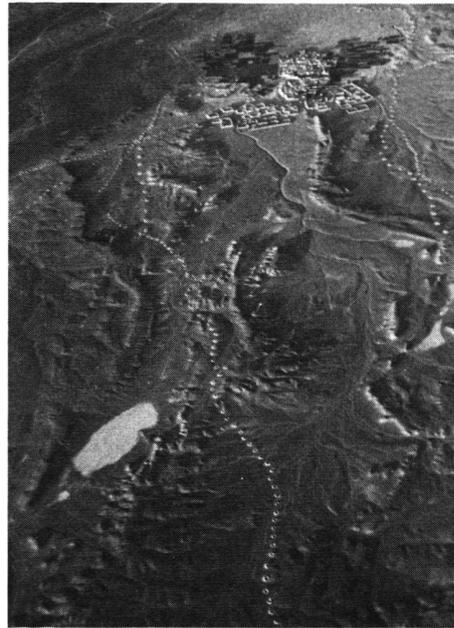
Fig. 3 Réseau de «Khanats» pour l'irrigation et l'alimentation en eau de boisson d'un oasis en Iran – vue aérienne à 10 000 m d'altitude
