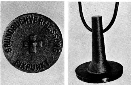
**Type A:** Zum Versetzen in Betonsockel. Bolzen  $\phi$  100, Höhe 120 mm,
