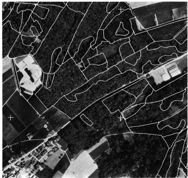
Abb. 2 Überlagerung eines Luftbildes (Aufnahmemassstab 1:25 000) neueren Datums mit einer fünf Jahre früher erstellten Bestandskarte. Deutlich lassen sich die inzwischen vorgenommenen Verjüngungen erkennen und auch nachtragen. Für die Bildüberlagerung wurde das Lineament der digitalen Bestandskarte projektiv verzerrt und der Geometrie des Luftbildes angepasst (Aufnahmen Eidg. Landestopographie Bern, reproduziert mit Bewilligung vom 23. 8. 1978).
