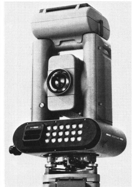
Auf den elektronischen Reduktionstachymeter Wild Tachymat TC1 kann eine Registriereinheit aufgesetzt werden (oben). Sie speichert sämtliche Messwerte eines Punktes mit einem einzigen Tastendruck auf Magnetbandkassette.
