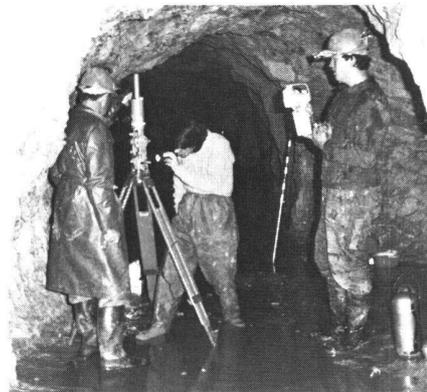
Fig. 7 Mise en station du gyroscope dans les galeries de drainage
