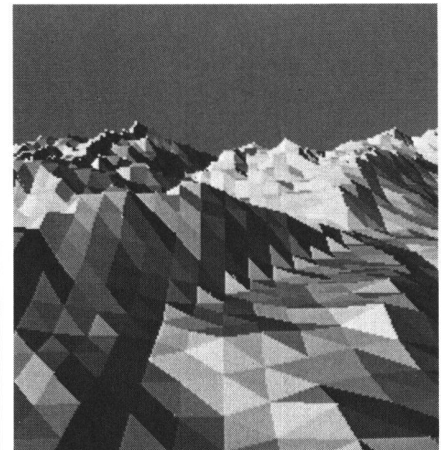
Abb. 8 Perspektivisches Schattenbild mit der Dreieckstechnik. Blick von Tour d'Ai (137/567.5/3000) nach Norden (Öffnungswinkel = 62°, Bodenneigungswinkel = 20°). Beleuchtung von SW. Sichtbar sind in der Bildmitte die Pointe d'Aveneyre und hinten von links nach rechts: Rochers de Naye, Cape aux Moines, Dent de Cordon, Vanil Carré. Am Ort des heutigen Lac de l'Hongrin ist auf dem Bild noch der Talboden sichtbar.
