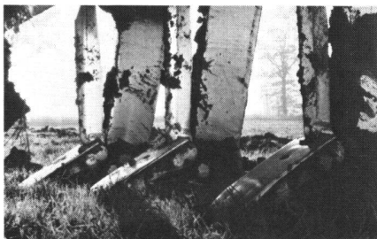
Abb. 5 Tieflockerungsmaschine mit dreischarigem Lockerungsaggregat
