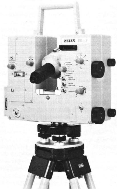
Zeiss Elta 2, Elektronisches Tachymeter mit digitalem Präzisionstheodolit, reduzieren dem elektro-optischen Distanzmesser aufbaufähig mit
