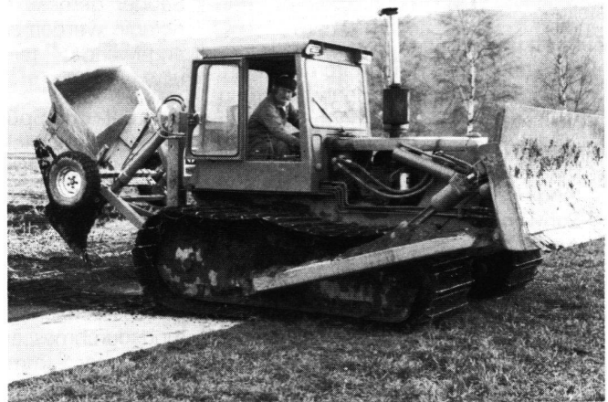
Abb. 4 Bulldozer D4D mit angebautem Schlitzdrainegerät
