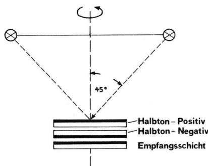
Abb.15 Beleuchtungsgeometrie und Kopieranordnung beim Tonlinienverfahren
