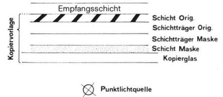
Abb. 22 Schematische Darstellung zur Herstellung von Amplitudenmasken
