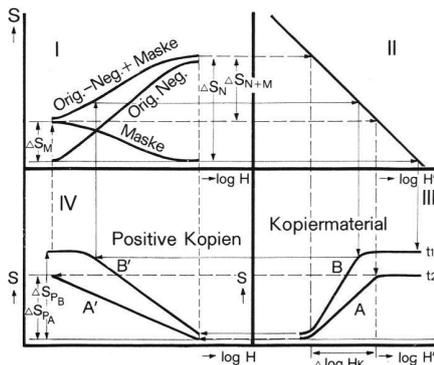
Abb. 5 Tonreproduktion eines Halbtonnegativs von reduziertem Schwärzungsumfang mit Hilfe einer Gradationsmaske. Von den Kopierschwärzungskurven A und B, mit den Entwicklungszeiten  $t_1$  und  $t_2$ , ist eine verzerrungsfreie Wiedergabe nur über das Kopiermaterial A mit  $\Delta \log H_K = \Delta S_{N+M}$  gegeben.
