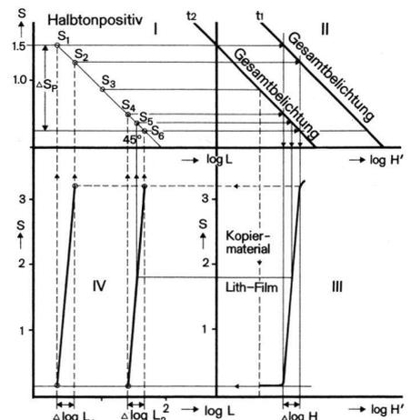
Abb.11 Wiedergabe ausgewählter Schwärzungsniveaus einer Halbtonvorlage mit einem Lithmaterial in zwei verschiedenen Gesamtbelichtungen  $t_1$  und  $t_2$
