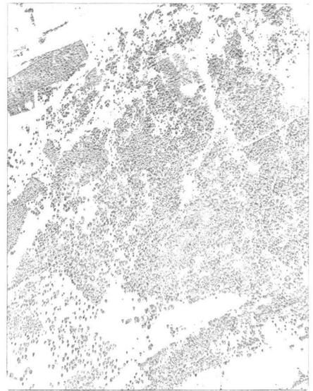
Abb.14 Der gleiche Sachverhalt wie Abb. 12, jedoch mit einem Rastertonwert von 40% in 120 L/cm Rasterweite aufgehellter Waldstruktur
