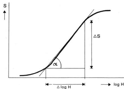
Abb. 1 Photographische Schwärzungskurve. Schwärzung aufgetragen in Funktion der Belichtung log H rel.
