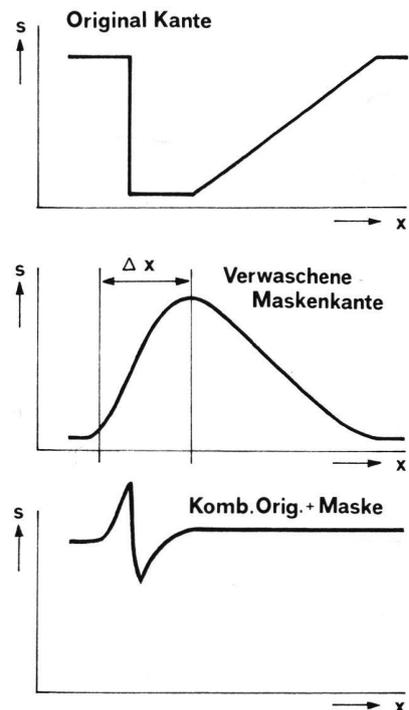
Abb. 20 Das Zusammenwirken einer Amplitudenmaske mit einer scharfen Originalkante  $\Delta X_0$  bei extremer Verwaschung  $\Delta X_M$  der Amplitudenmaske. Die dargestellte Gradienten-Veränderung entspricht  $\gamma \approx 1$
