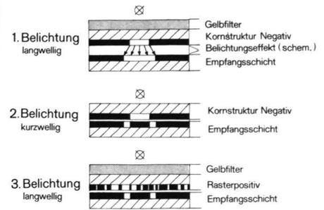
Abb. 27 Schematische Darstellung des Belichtungsablaufes für die Kombination von Kornstruktur- und Rasterbildern mit Umkehrfilmen, die den Herscheleffekt zeigen.
