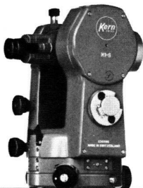
Kern K 1-S. Ingenieurtheodolit mit Skalenablesung
