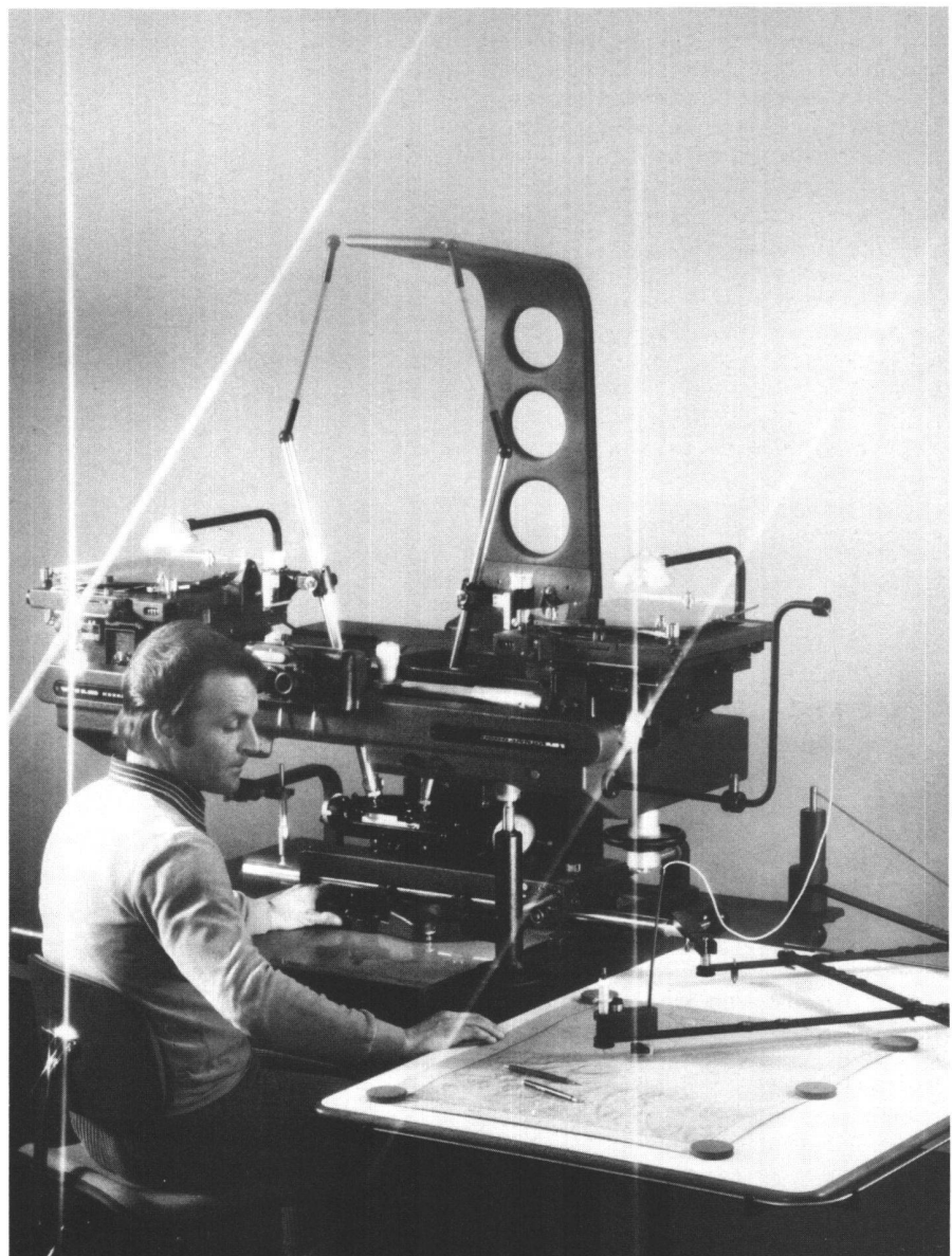
Abb. 2 Der Wild AG1 – das neueste Modell der erfolgreichen Aviograph-Linie. Besonders hervorstechendes Merkmal neben der erhöhten Genauigkeit ist die ergonomisch optimale Anordnung sämtlicher Bedienelemente in bequemer Reichweite des Operators. Die Pantograph-Zeichnung entsteht lageorientiert zum Operateur.
