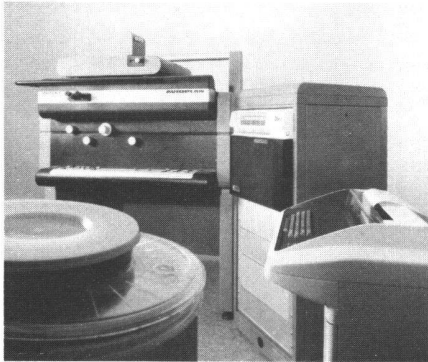
Abb.5 Für das Orthophotosystem Wild Avioplan OR1 liefert der Wild AG1 die Steuerdaten zur Entzerrung der Aufnahmen. Der Abgriff der Daten kann auf verschiedene Weise und weitgehend automatisiert erfolgen.
