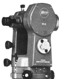
Kern K 1-S. Ingenieurtheodolit mit Skalenablesung
