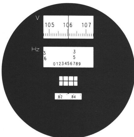
Im schwenkbaren Ablesemikroskop des neuen Wild TO sieht der Beobachter beide Kreisbilder auf einen Blick. Zur Vermeidung von Verwechslungen ist der Vertikalkreis blau, der Horizontalkreis gelb beleuchtet. Sind die Gradteilungsstriche mit dem grossen Mikrometertrieb genau koinzidiert, so kann man den Horizontalkreis digital (357,839) und den Vertikalkreis auf der Skala (106,049) ablesen.
