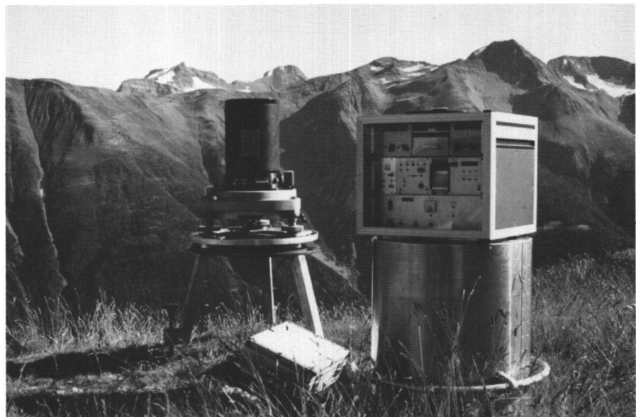
Abb. 5 Die neueste Version der an der Technischen Universität Hannover im Auftrag des IGP gebauten transportablen Zenitkamera TZK 3. Auf dem Stativ steht der Kamerakörper mit Objektiv, Drehkreis, elektronischen Libellen, Kassettenfach (unterhalb des Drehkreises) und Horizontierfüßen. Neben der Kamera befindet sich auf der Abdeckhaube die Elektronikeinheit. Sie enthält die Stromversorgung, die digitalen Anzeigen für die elektronischen Libellen, die Elektronik zur automatischen Ablaufsteuerung der einzelnen Belichtungen, die Uhr mit Präzisionsquarz, den Langwellenempfänger, einen Kleindrucker sowie ein mikroprozessorgesteuertes Datenerfassungs- und Speichergerät, welches eine Kapazität von 19 kByte aufweist.
