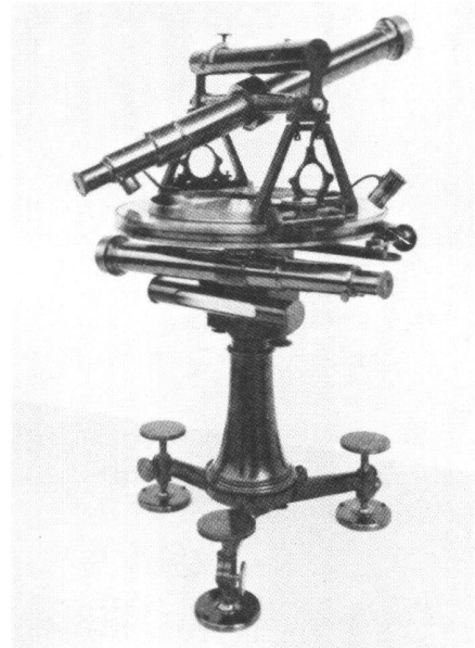
Abb.10 8" Theodolit von Reichenbach 1819, von Pestalozzi für die eidgenössische und später für die kantonal-zürcherische Triangulation verwendet
