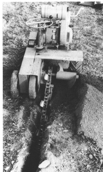
Abb. 6 Handliche Klein-Grabenfräse Ditch-Witch mit 9 PS, einer Arbeitstiefe von bis 50 cm und Grabenbreiten von 8, 16 und evtl. 24 cm.
