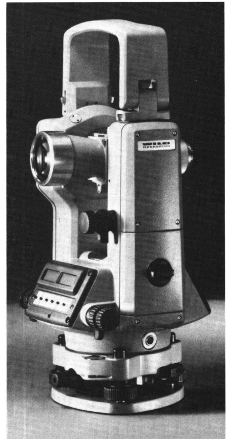
Der neue elektronische Theodolit Theomat Wild T1000 ist einfach zu bedienen und bildet das Zentrum eines wirtschaftlichen und vielseitig nutzbaren Tachymetersystems. Selbst mit Batterie und aufgesetztem Distomat DI1000 wiegt er nicht mehr als 7 kg.
