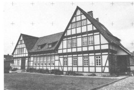
und Mittelbildformat aufgenommen. Vor der Filmebene ist eine hochgenau vermessene Gitterplatte mit Messkreuzen eingebaut, die bei der Aufnahme mit abgebildet werden. Das ist Voraussetzung dafür, dass bei der Auswertung Fehler durch Filmverzug und unzureichende Filmplanlage ausgeschaltet werden.
