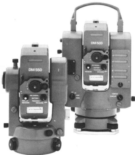
Der DM 550 misst den Vertikalwinkel und reduziert die gemessene Distanz **automatisch auf Horizontalabstand**.
