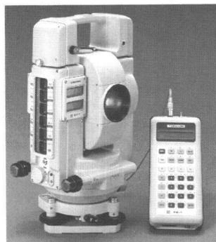
Die Totalstation Et-1 ist das Flaggschiff einer kompletten Gerätefamilie für die computer- unterstützte und millimetergenaue Vermessung. Reichweiten von bis zu 2600 m, elektronische Winkelmessung, berührungsfreie Bedienung, automatische Kompensation der Erdkrümmung und externe Datenspeicher sind nur einige der vielen Rosinen.
