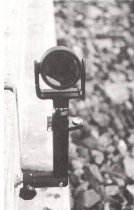
Abb. 6: Bei verdeckten Bolzen wird die «Perronhalterung» eingesetzt. Die Genauigkeit der Dosenlibelle von 10–15' ermöglicht eine millimetergenaue Höhenverlegung des Bezugspunktes.
