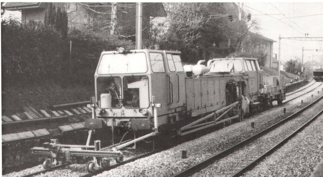
Abb. 12: Gleisrichtmaschine mit Messwagen und Steuerpult im Kommandoraum.
