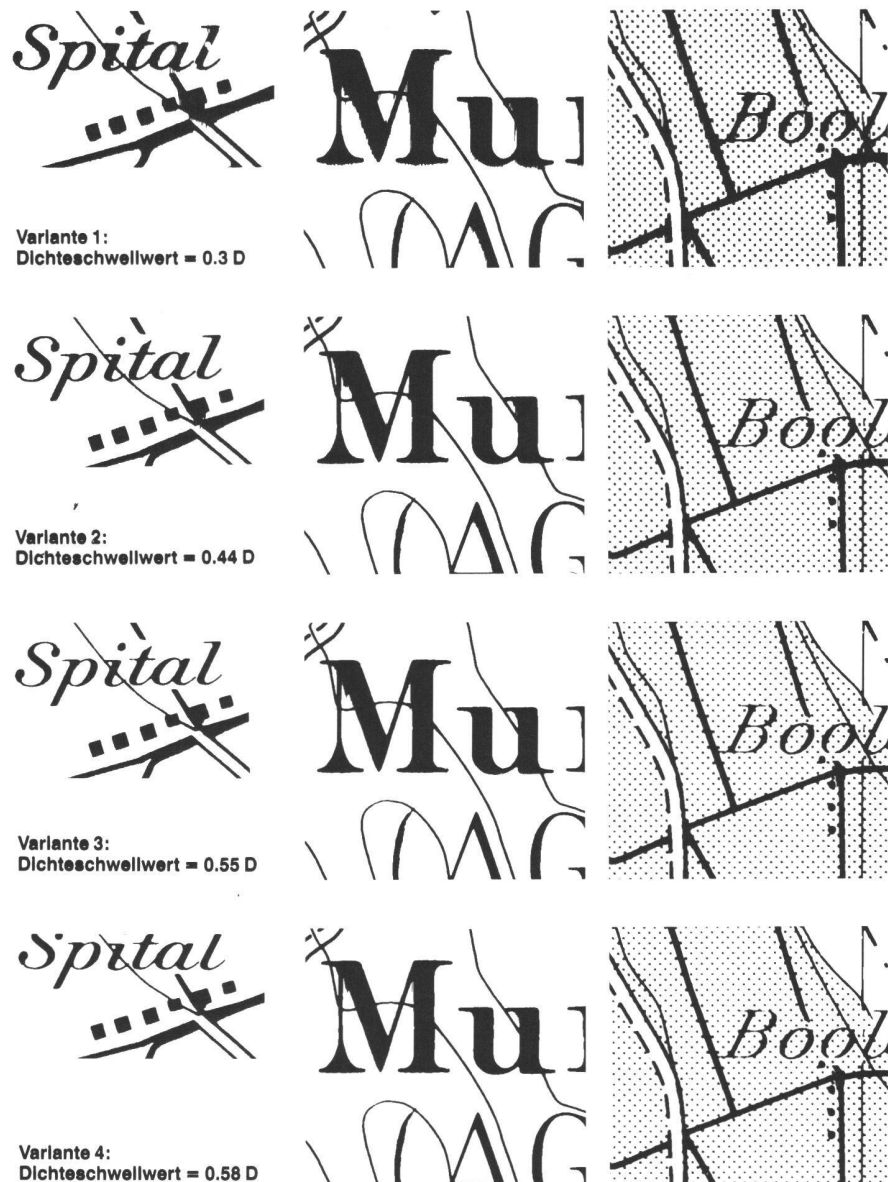
Abb. 5: Drei Ausschnitte aus dem totalen Bild der LK 1:50 000, gescannt bei einer Auflösung von 12,5 µm und mit 4 verschiedenen Dichteschwellwerten für die hellsten noch zu erfassenden Bildelemente. Ca. 5-fache Vergrösserung.
