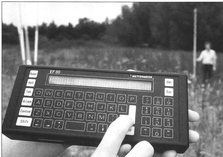
Das Elektronische Feldbuch EF 80 ist ein kompakter leistungsstarker Feldcomputer. Durch einfache Menüsteuerung kann der Anwender aus einer großen Anzahl von Tachymetern sein Meßgerät selbst wählen.
