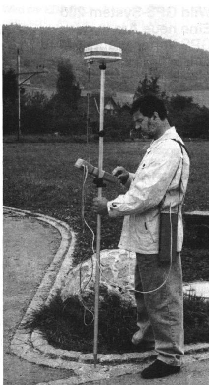
Abb. 1: Beispiel für Aufstellung mit Lotstock, für «Stop and Go» (mobiler Empfänger).
