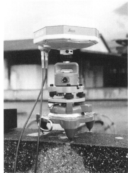
Abb. 2: Aufstellung der Antennen.
