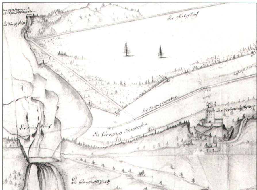
Abb. 5: Ausschnitt aus Samuel Bodmers Plan und Grundriss des unteren Kanderlaufs nach 1711. Datiert 1717. Die Abbildung zeigt die Partie des Durchstichs kurz vor dem Einsturz des ursprünglich geplanten Stollens (AA V 413).
