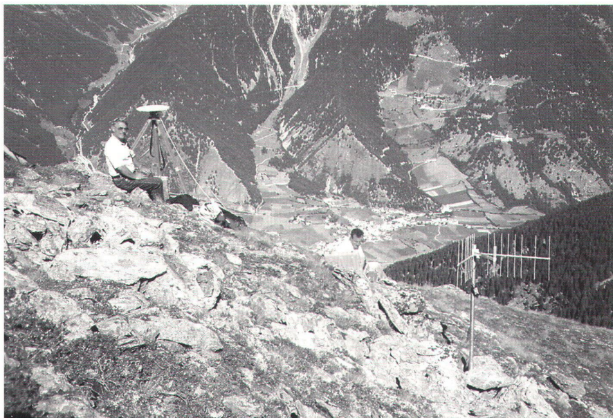
Fig. 1: Station de référence RTK avec l'émetteur radio muni d'une antenne directionnelle.
