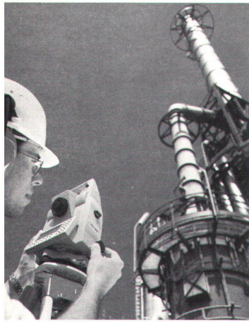
Abb. 2: TCR Instrumente ermöglichen Punktbestimmung und präzise Distanzmessung ohne Prismen bei schwer oder gar nicht zugänglichen Zielen.
