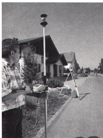
Abb. 3: Mit der neugestalteten RCS1100 Fernsteuerung lassen sich Daten und Zusatzinformationen genau dort erfassen, wo sie anfallen: direkt am Messpunkt. Über Funk kann man sämtliche Funktionen des TCA Tachymeters aufrufen.
