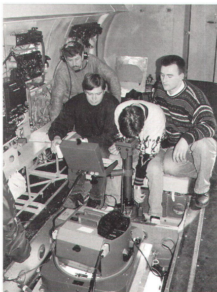
Abb. 4: Leica RC 30 mit ASCOT-Bildflugmanagement-System. Die Platzverhältnisse in der Antonov-30 erlauben Operator-Schulungen während des Fluges.
