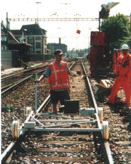
Abb. 7: Gleismesswagen.
