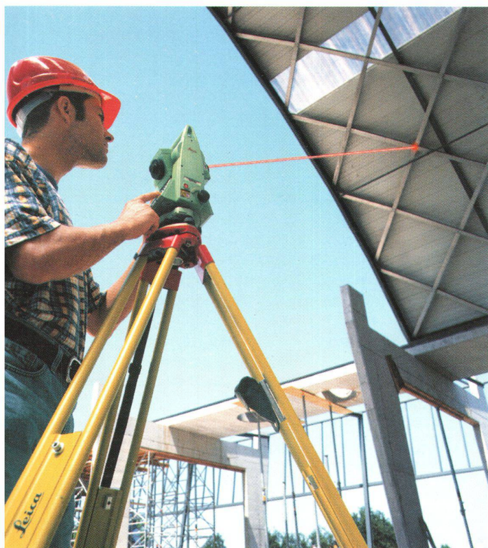
Fig. 2: Mesure sans réflecteur avec le TCR702. Rapide et pratique. Le rayon laser visible permet de visualiser précisément la cible sans que l'utilisateur ait à regarder par une lunette.
