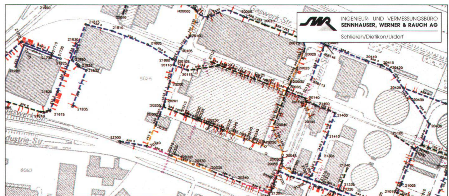
Abb. 4: Abwasser-Zustandsplan (z.v.g. von Sennhauser, Werner & Rauch AG).
