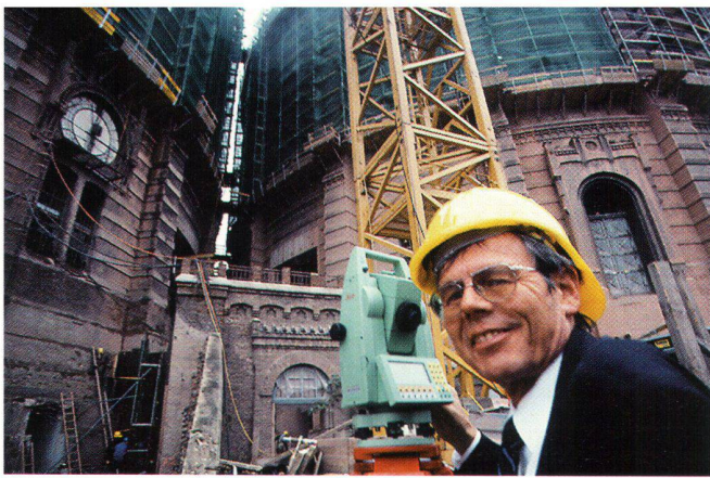
Abb. 8: Porr Chefvermesser Hans-Peter Blaha bei der schnellen berührungs- und reflektorlosen Erfassung der Gasometerstruktur.
