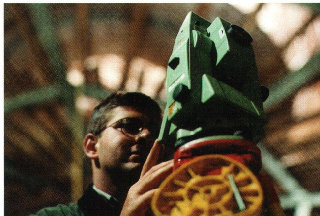
Abb. 4: Stefan Götz erfasst mit dem Leica TCRA1105 in automatisierter reflektorloser Messung die Kuppelstruktur. Foto: Porr/Rappersberger.
