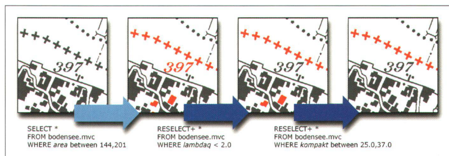
Abb. 5: Objektmerkmalsbasierte Abfrage für die Grenzlinie: Die hintereinander ausgeführten Abfragen nach den Merkmale Fläche (area), Hauptachsenverhältnis (lambdaq) und Kompaktheit (kompakt) führen zur sukzessiven Eingrenzung des Resultats.
