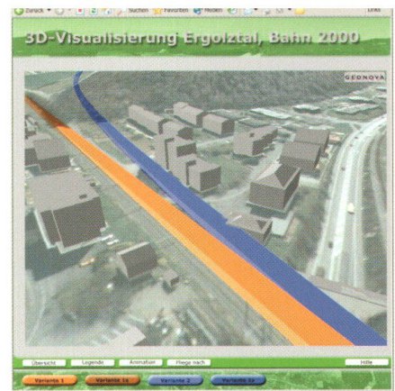
Abb. 2: Variantenstudie Linienführung Bahn 2000 Wisenbergtunnel (© FHBB, Muttenz).
