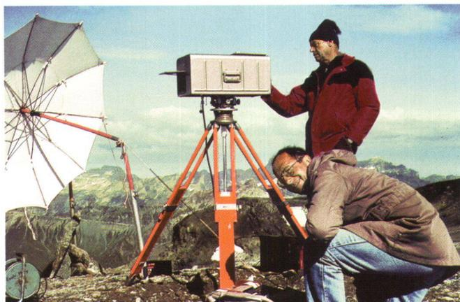
Abb. 3: EDM-Station (Laser-Geodimeter 8) Vorab.
