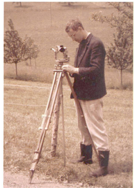
Abb. 3: Reduzierender Doppelbild-Tachymeter in einen Kontakt-Tachymeter der Firma KERN eingebaut. Solche Geräte standen noch bis anfangs der 60er-Jahre im Einsatz. Da kein optisches Lot vorhanden war, musste mit Senkblei oder Zentrierstock gearbeitet werden. Dieses Gerät wog 6,5 kg.
