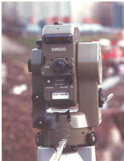
Abb. 6: KERN DM-500/501. Obwohl die gemessene Distanz noch reduziert werden musste (Rückschritt) und die Höhenunterschiede separat berechnet werden mussten, war nun die Ära der mechanisch-optischen Tachymeter endgültig Vergangenheit.
