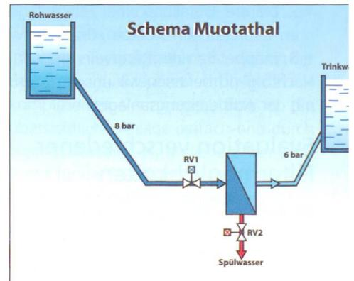
Abb. 1: Schema Druckverhältnisse (Quelle: Membratéc AG, Sierre).
