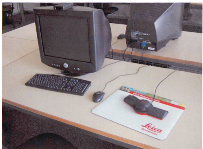
Photogrammetrie WS mit Leica Geosystems TopoMouse.
