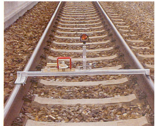
Abb. 7: Gleislehre zur Aufnahme der Ist-Gleislage.
