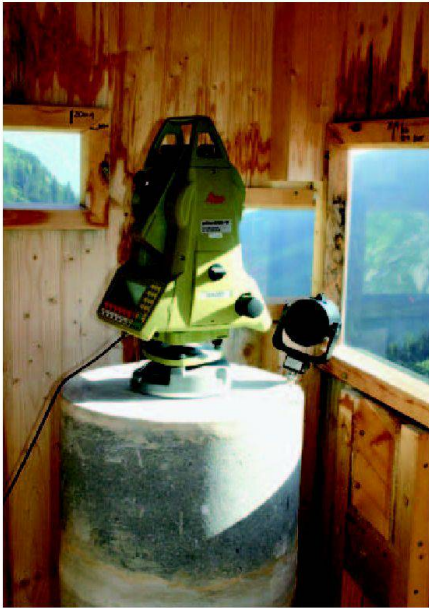
Abb. 3: Tachymeter auf doppelwandigem Pfeiler in Schutzhaus.
