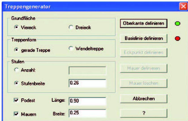
Erweiterte Anwenderfunktionalität: Treppengenerator.
