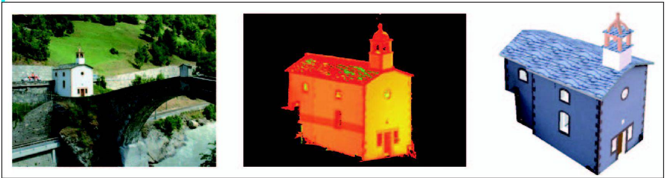
Abb. 4: Situation (links), 3D-Punktwolke (Mitte) sowie abgeleitetes 3D-Modell der Kapelle von Neubrück (rechts). Zusätzlich sind auf das 3D-Modell Bilder projiziert, um ein der Realität entsprechendes Modell zu erzeugen.
