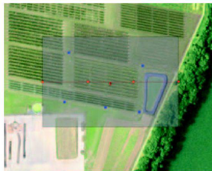
Abb. 2: Flugplanung mit dem durch die Bilder abgedeckten Bereich (grau) und den eingezeichneten Passpunkten.
